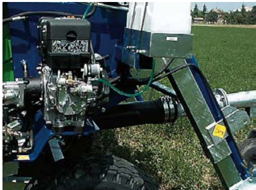
СМОТКА ПРИ ПОМОЩИ ДВИГАТЕЛЯ
