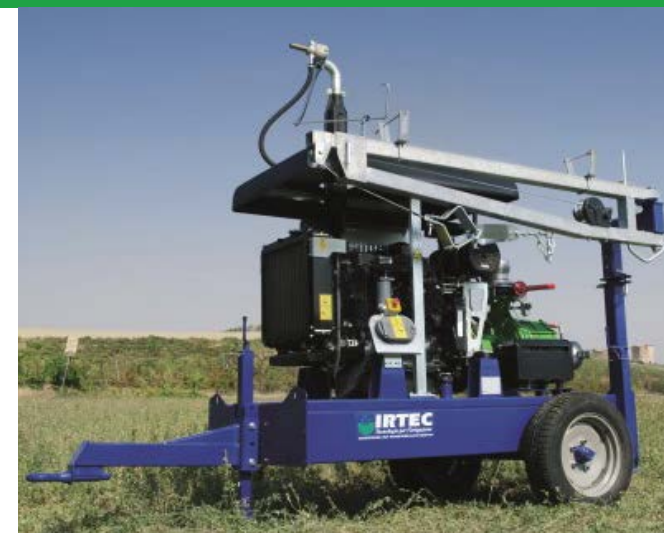
ДИЗЕЛЬНАЯ НАСОСНАЯ СТАНЦИЯ
